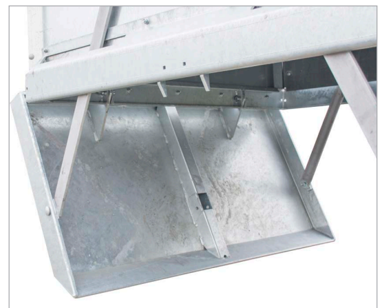
Scharnieren integraal onderdeel van de bodemklep ---> hoge sterkte
