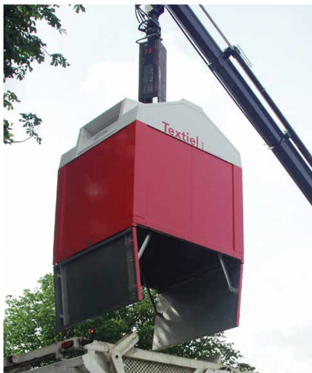
Opróżnianie za pomocą dźwigu poprzez otwarcie dolnych kłap
