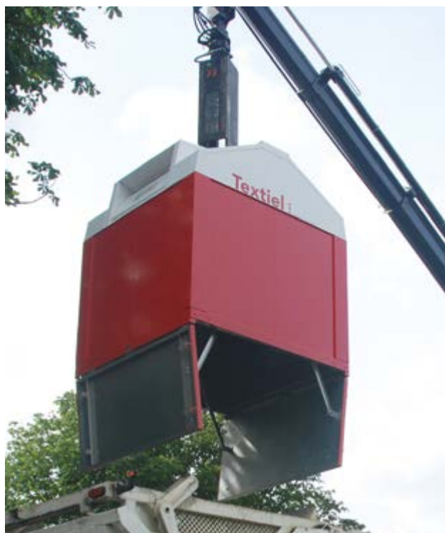
Le valvole di fondo vengono aperte per lo svuotamento utilizzando un carro gru
