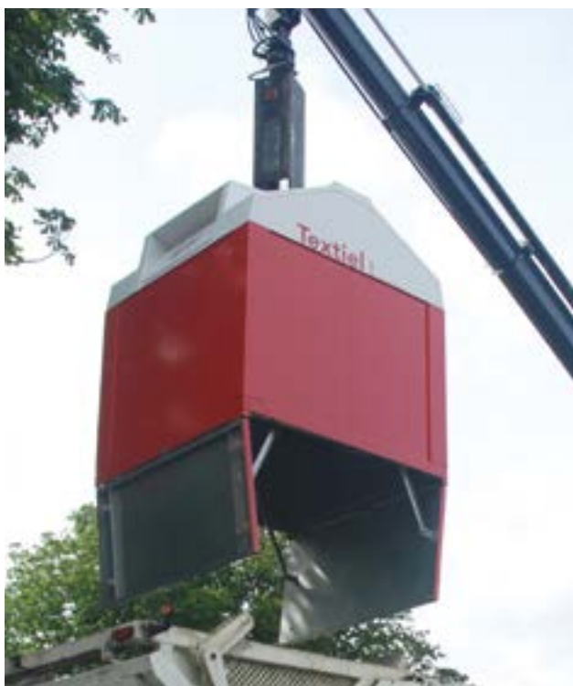
Lukene åpnes for tømming ved hjelp av lastebilkran
