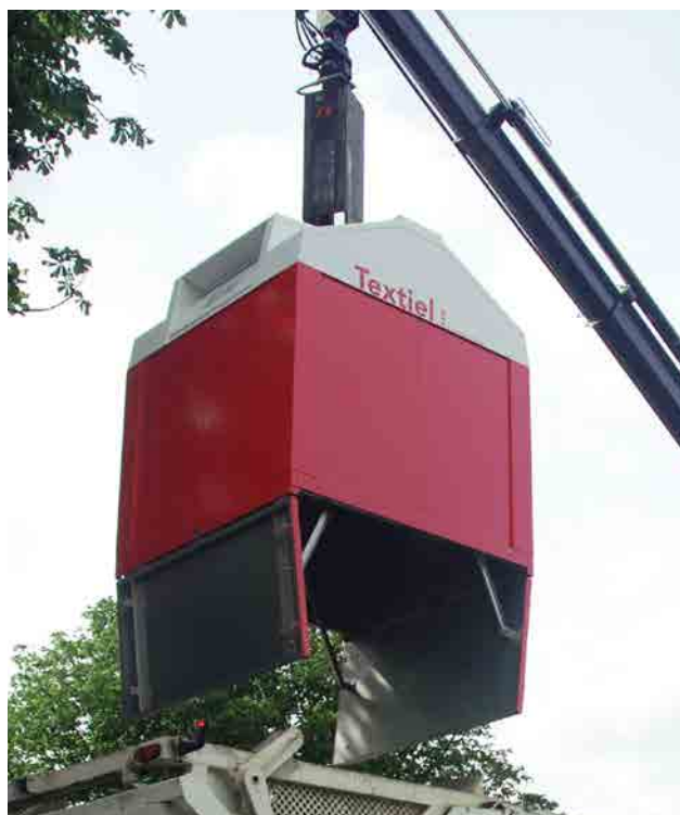
Bottenluckan öppnas för tömning med hjälp av en lyftkran
